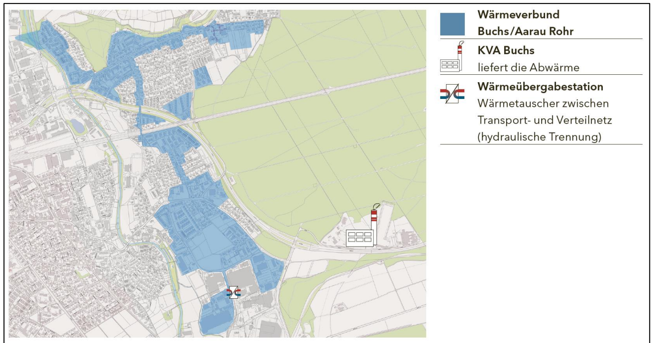
Der geplante Wärmeverbund Buchs / Aarau Rohr bezieht die Abwärme von der Kehrichtverbrennungsanlage Buchs via Transportnetz FEWAG.
